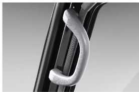
Assist Grip untuk memudahkan keluar masuk kendaraan
